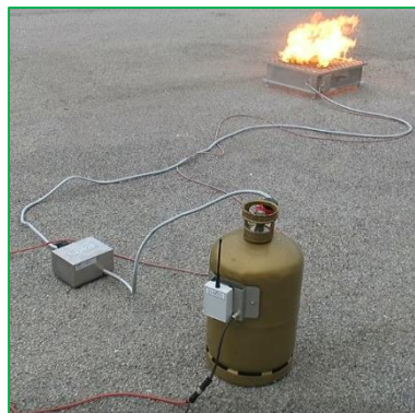
GF42 mit Magnetventil-Modul und angeschlossener Funkfernbedienung
