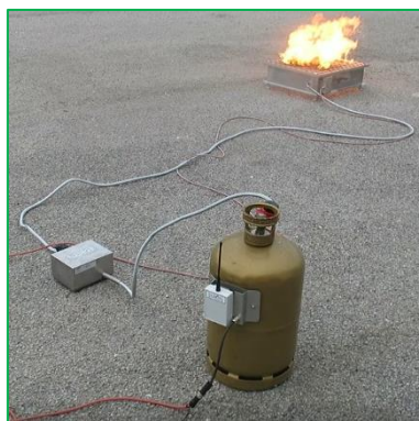
GF42 et son module électrovanne utilisant l'option télécommande sans fil
